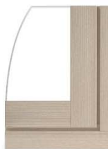
Rahmen und Flügel flächenbündig Verdeckt liegende Beschläge
